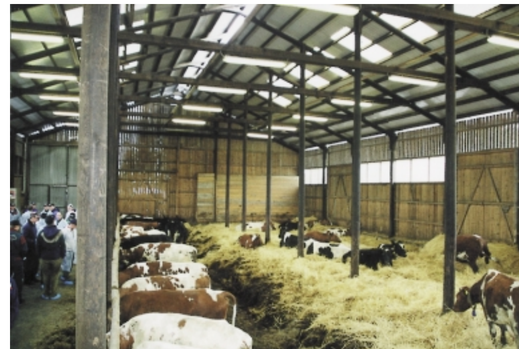
■ Driftsbygningen på Antila var reist med kreosotimpregnerte stolper og egne materialer.
