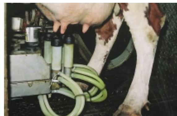
■ Laseren sikter inn spenene og styrer spenekoppene på plass.
