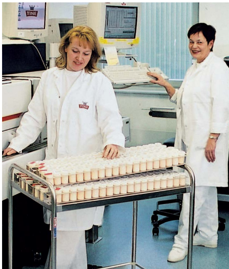
■ I dette laboratoriet i Brumunddal analyseres tankmjølk på fett, protein, laktose, celler og urea to ganger i måneden fra nær 5 000 buskaper. I tillegg analyseres mjølk fra minst seks uttak per år fra enkeltkyr i de samme buskapene. Maskinen har en kapasitet på 500 prøver per time, forteller arbeidsleder Edit Esbjørnsen (til h.) her sammen med operatør Hilde Bekkevold. Foto: hah
