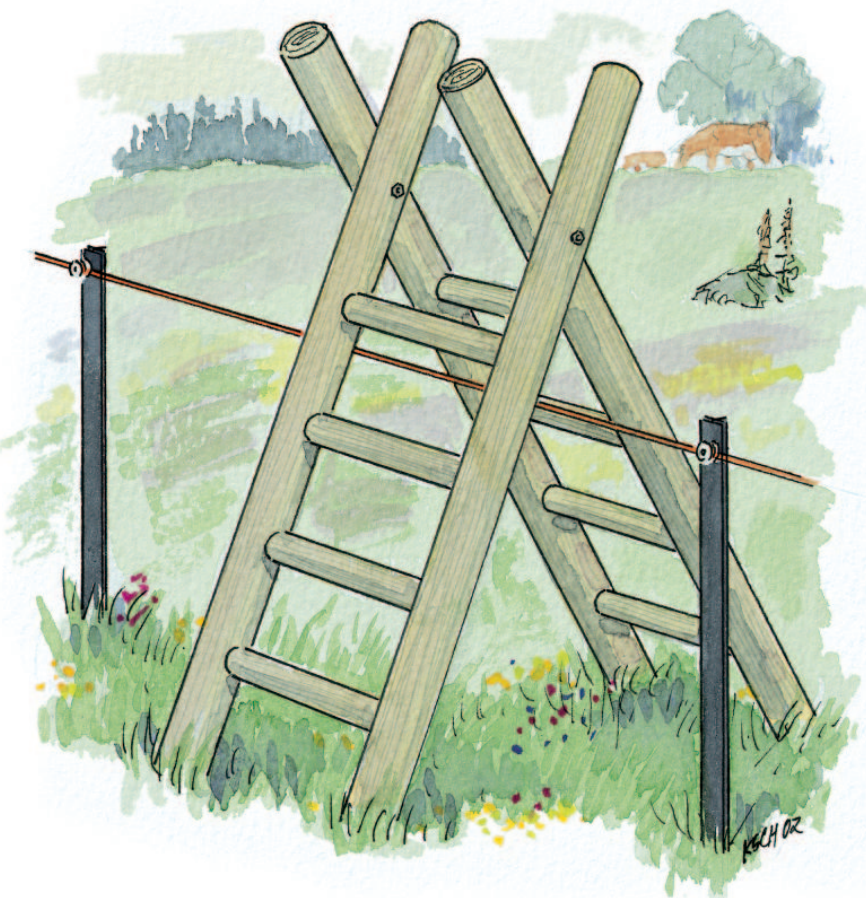
■ Et klyvele kan for eksempel lages som på illustrasjonen.
