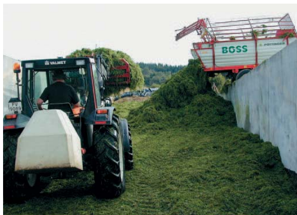
■ Har en bygd plansiloen i en skråning, kan en støpe en kjørbær plattform langs sida, og tippe lass derfra.
