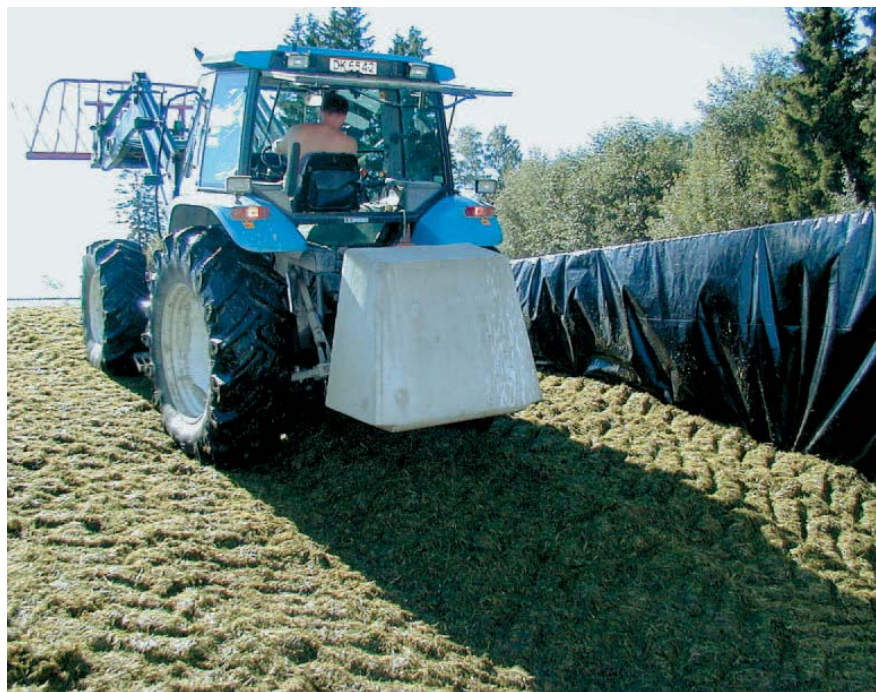
■ God pakking med tung traktor er avgjørende for å få god surfôrkvalitet i plansilo. Alle bildene er tatt av Odd Helge Johnsen.
