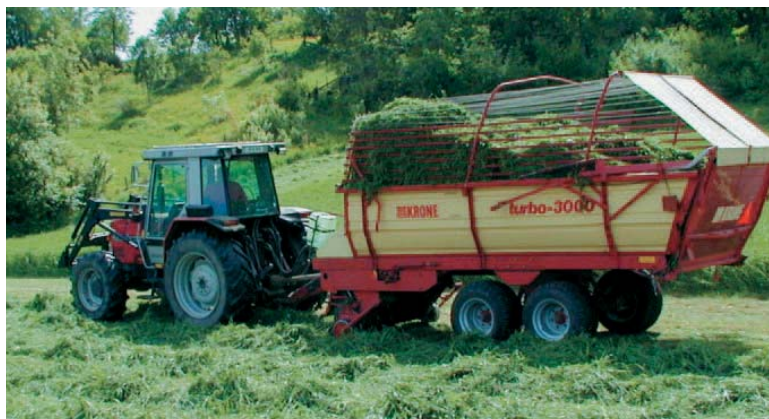
■ Lessevogn har stor kapasitet, men snitter grasets dårligere enn en eksaktthøster.
