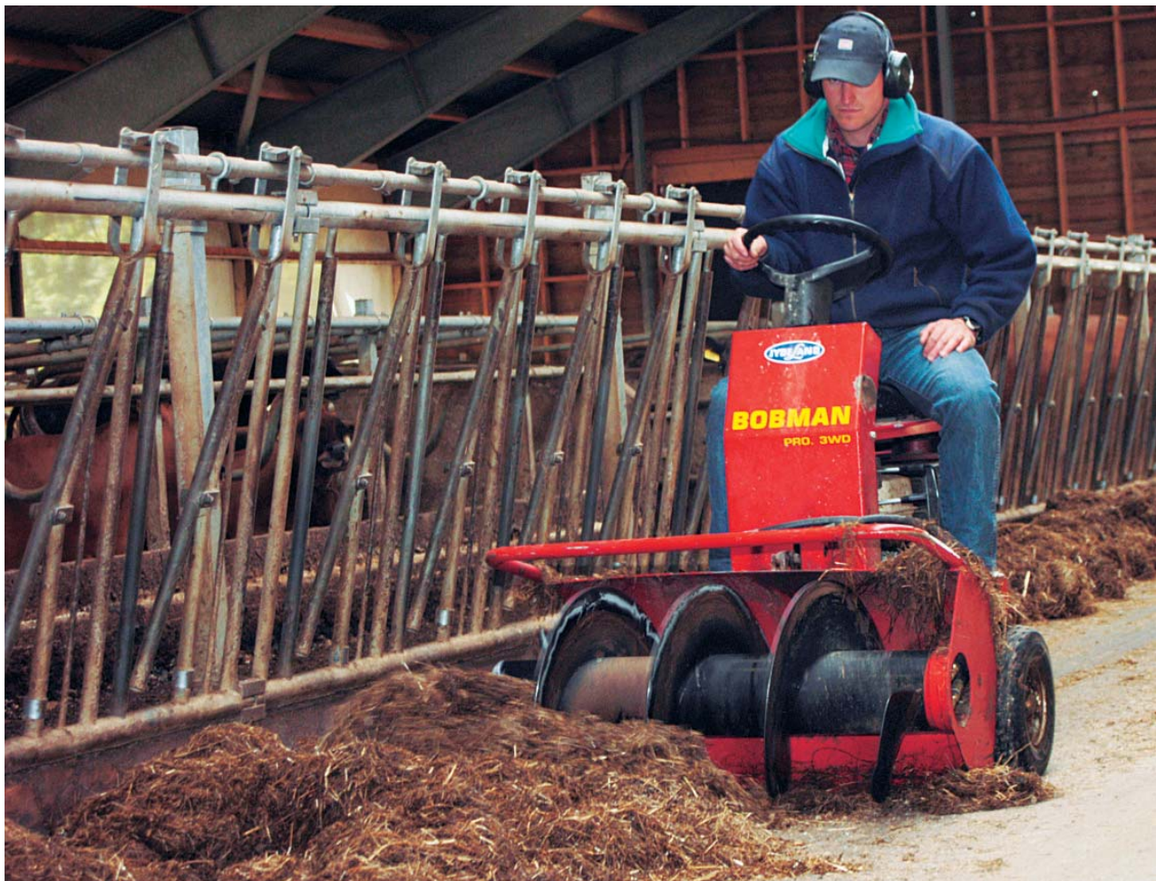
■ Med denne kjøredningen skyfles fôret inntil kyrne. Den brukes også til å skrape møkk i bingene. Da skiftes trommelen ut med et skjær og reinholdet er selvsagt viktig før man kjører på fôrbrettet igjen.
