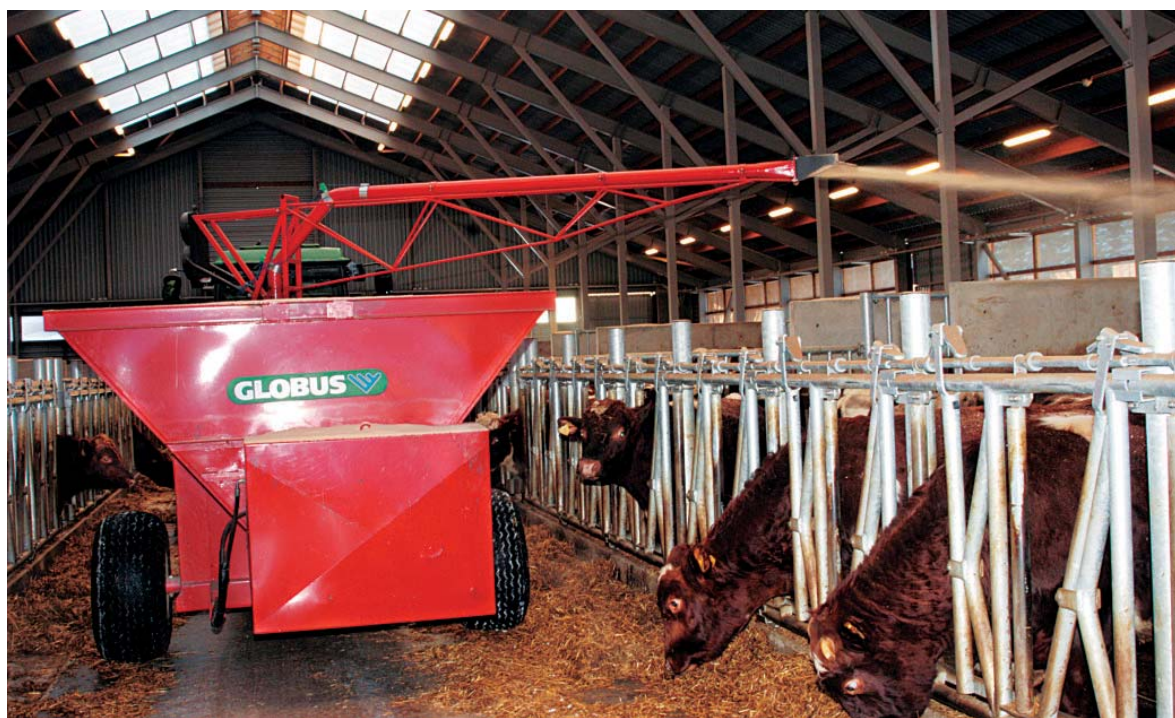
■ Globus i Brumunddal har utviklet en prototyp av en flisutlegger som nå fungerer meget bra. Foto: Rasmus Lang-Ree.
