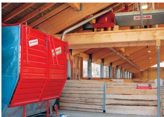
■ Stroh-Matic er en nykommer på det norske markedet. Anbjør sier at de ville ha tråkk-talle i bingene, men at det fikk en del innspill i planleggingsfasen om at dette ikke alltid fungerte. I Stroh-Matic legges halmballen i ei vogn der halmen kuttes før den transporteres ut til hver bing. Når halmen kuttes økes absorpsjonsevnen betydelig, og dette skal gi et redusert halmbehov på 40 til 50 prosent sammenlignet med langhalm. Halmen transporteres i kanaler med transportbånd, og nedslipp styres med åpninger i kanalene (manuell stenging/åpning). Transportbånd kan være fordelaktig i forhold til støv sammenlignet med løsninger der strøet blåses ut i bingen med vifter. Fra den østerrikske produsenten fikk Buskap oppgitt en pris på 30 000 euro (235 000 kroner) for et slikt anlegg.
