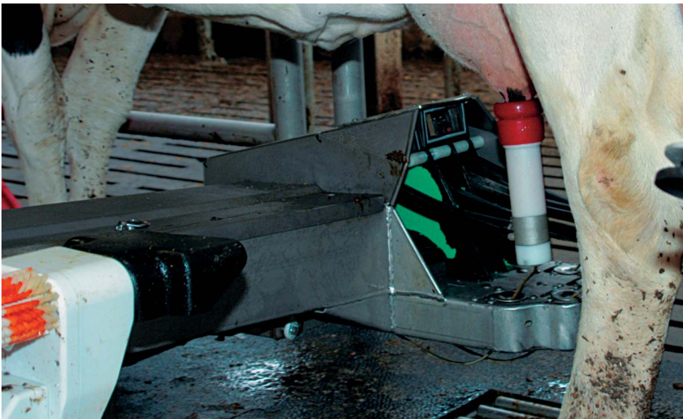
■ Vektsensorer i gulvmatta gjør at robotarmen kan følge kuas bevegelser under melking.
