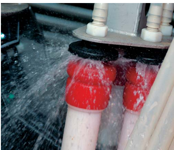
■ Som tilleggsutstyr er det mulig å få rengjøring med vanddamp som et alternativ til den vanlige vaskeprosedyren. Dette kan være aktuelt i en situasjon med mastittproblemer i besetningen.
