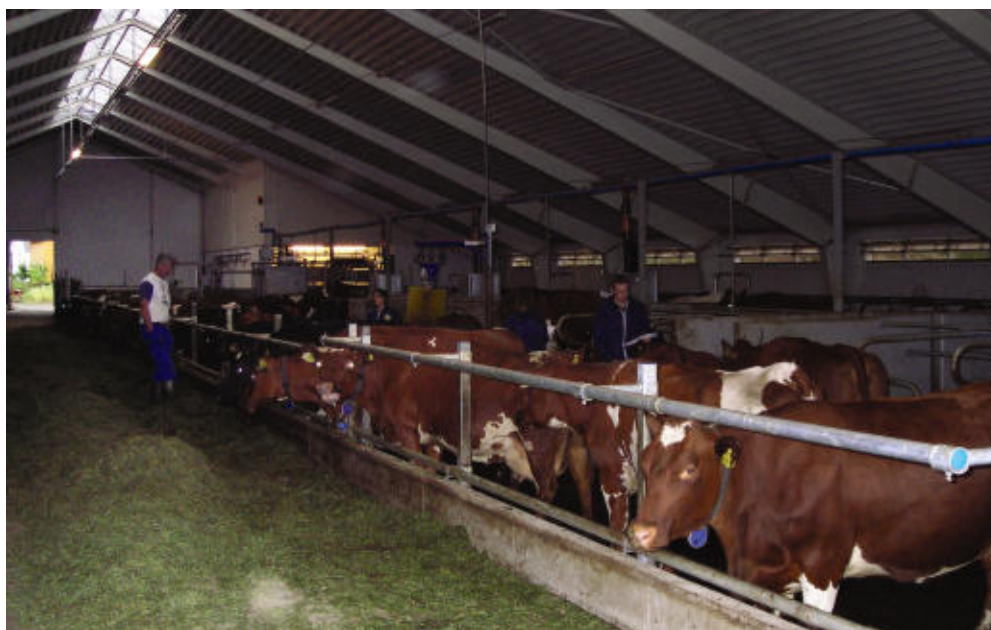
■ I fjøs med store vegg- og takflater i forhold til dyretallet kan varmembalansen bli negativ. Derfor bør varmembalanseberegning utføres før byggingen tar til. Foto: Lars Erik Ruud.
