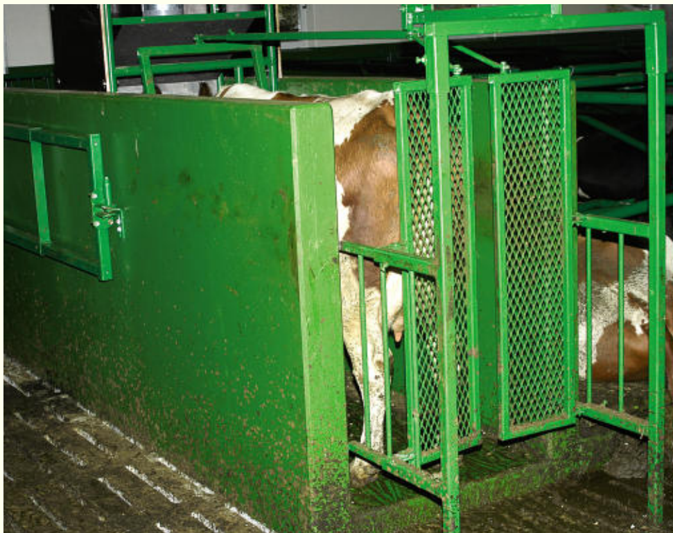
■ Kraftfôrautomatene har porter og tette sidevegger. Sideveggene er støpt fordi det var billigste løsning.
