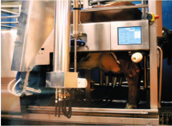
■ VMS 2007 har et vannforbruk på om lag 750 liter i døgnet inkludert automatisk spyling av golvmatta i roboten.
