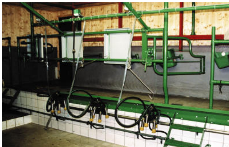
■ Fiskebeinstallen er en funksjonell og godt utprøvd løsning for mjølking i løsdrift. Den kan leveres svært enkelt utstyrt slik som bildet viser, eller også med utstyr som automatisk avtak med mer. Foto: Lars Erik Ruud.
