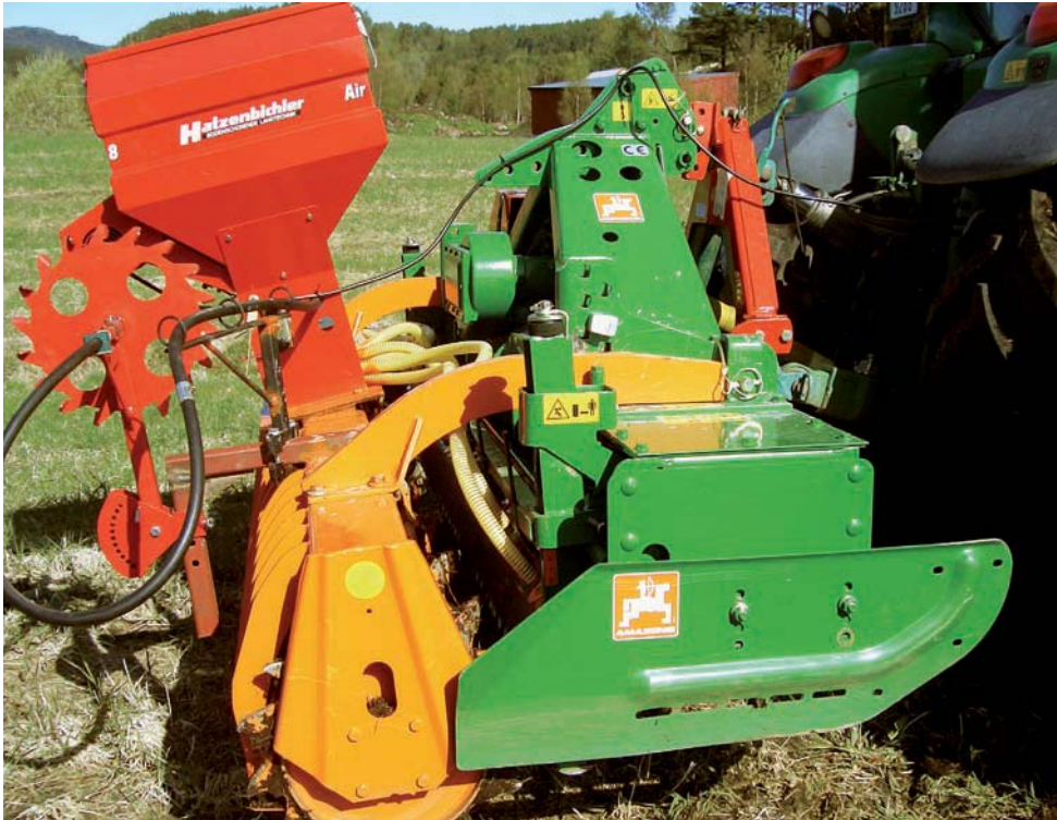
■ Fres med såmaskin: Hjemmelaget sammenbygging av horisontalroterende fres og såmaskin.
