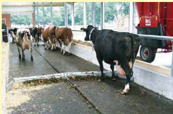
Gjødselskraper for fjøs med liggebås. Gummimatter for skrapeareal leveres på rull, skreddersydd for dine mål.
