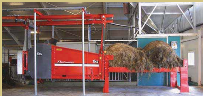
TKS feed-robot med automatisk reservoar.
