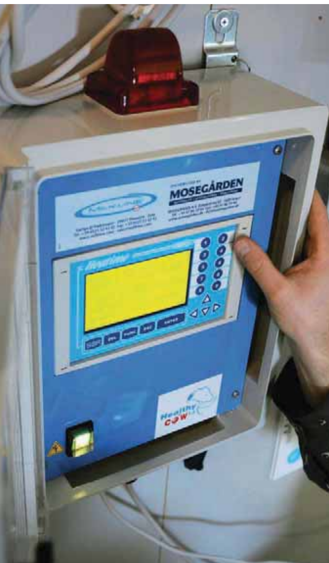
■ Heatime er enkel å betjene. Ved alarm lyser lampen oppe på boksen. Foto: Rasmus Lang-Ree
