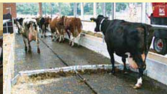
Gjødelskraper for fjøs med liggebås. Gummimatter for skrapeareal leveres på rull, skreddersydd for dine mål.
