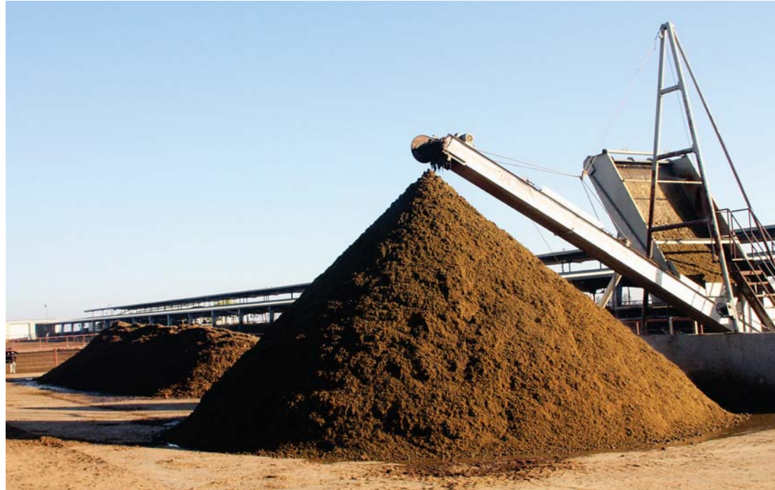
Gjødsel separeres i en tørr og en flytende del. Tørr gjødsel brukes som strø/underlag i liggebåsene.
