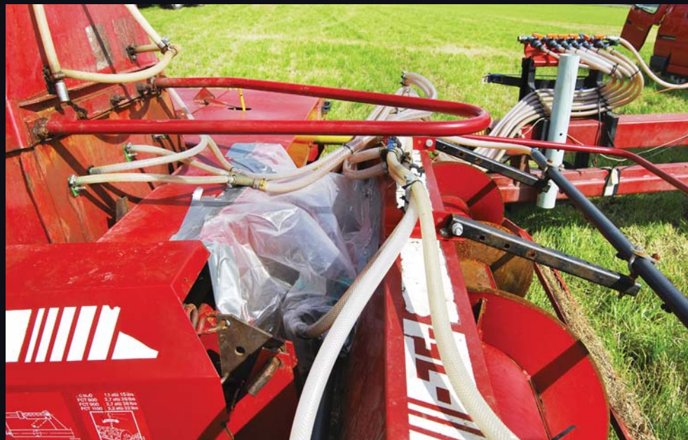
Eksakthøster med innmatingskanal dekket med plast for å redusere spill. Foto: Matts Nysand
