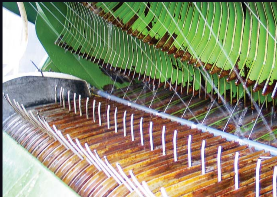
Finsnitter med spaltspreder oppe og rampe nederst. Deling av tilsettinga slik at halve mengda kommer nedenfra og halve ovenfra gir jammere innblanding og fordeling i graset. Foto: Matts Nysand
