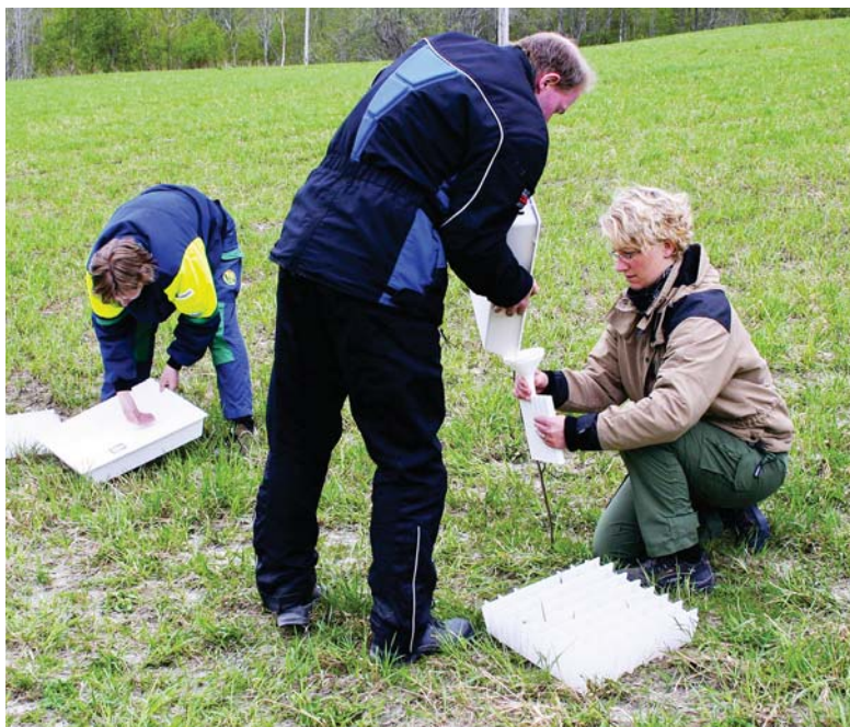
Spredjevnheten kontrolleres med syv spredebakker
