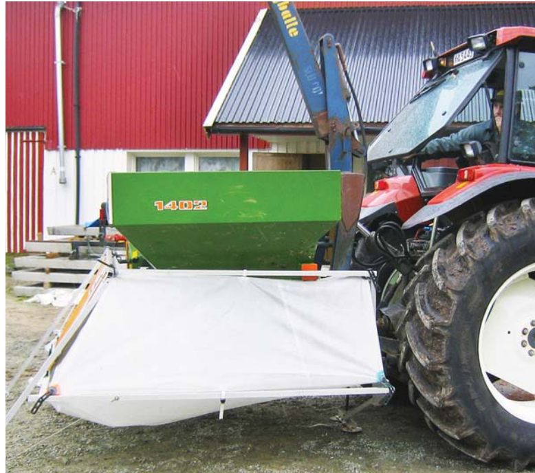
Med gjødselsamleren kontrolleres sidefordeling av gjødsla (skjevt spredebilde) og gjødselmengde
