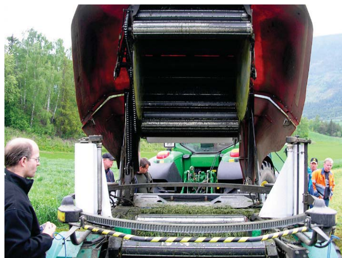
Innstilling av rundballepresser, type og kjøremåte påvirker hvor mye gras en får inn i rundballen. Foto: Eivind Bergseth
