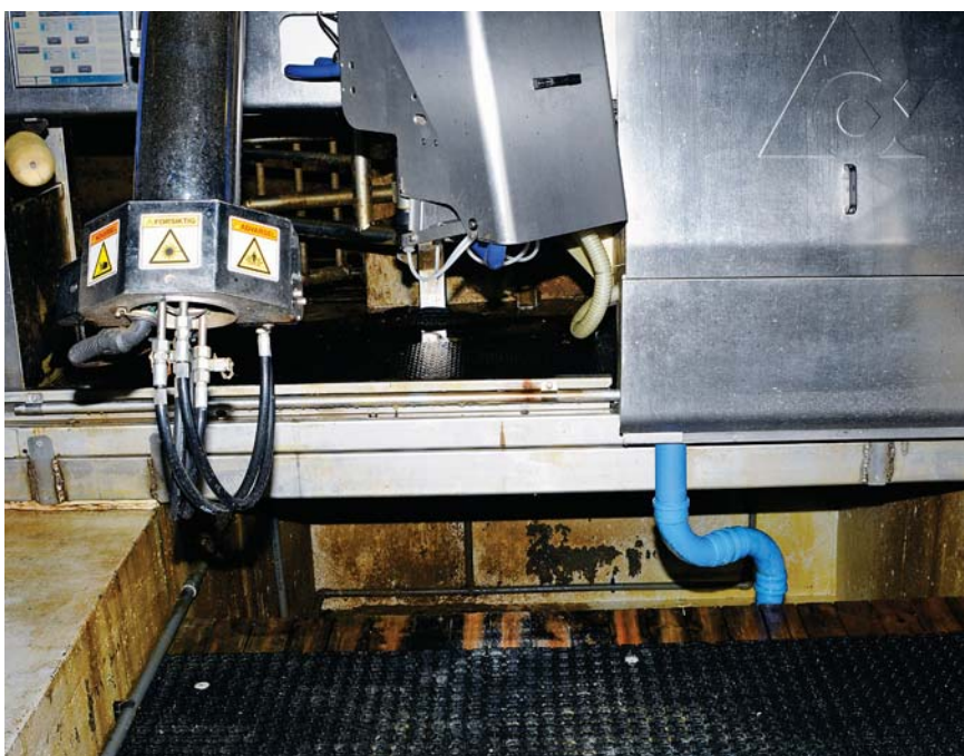
Grav foran roboten er en spesielløsning som gjør at bonden slipper å stå på kne, men som kanskje ikke er like populær hos servicepersonell som må bruke stige for å nå opp på roboten.
