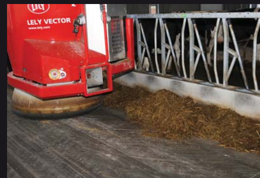
En stund etter utfôring kommer roboten og skubber inntil fôret og med laster registreres samtidig hvor mye som er igjen som i neste omgang bestemmer når neste utfôring skal skje.
