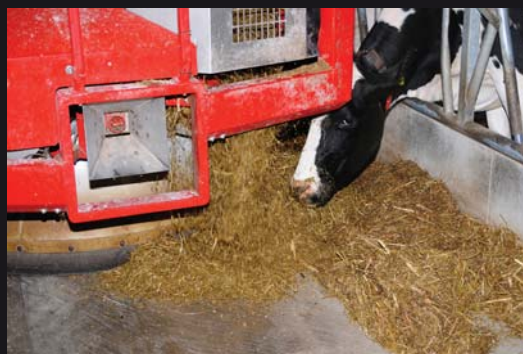
Kjørehastigheten regulerer mengden som utfôres slik at den blir som bonden har programmert.
