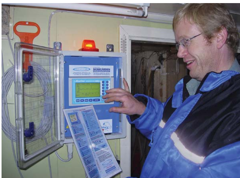
Når den røde lampen blinker betyr det at det er registrert brunst på ett eller flere dyr.
