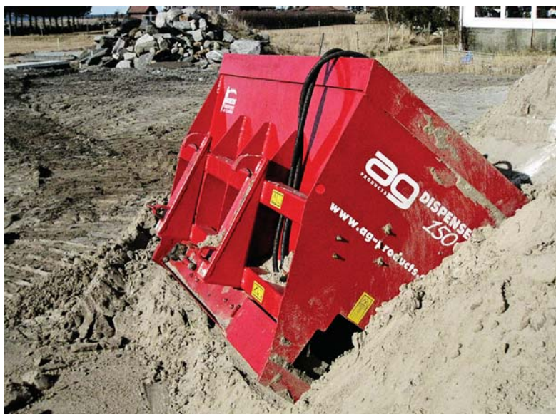
Sandstrøpparatet som, når det vert brukt på lesseapparatet, kan strø dobbelrekkja frå ein av skrapegangane. Foto: Inga Skretting
