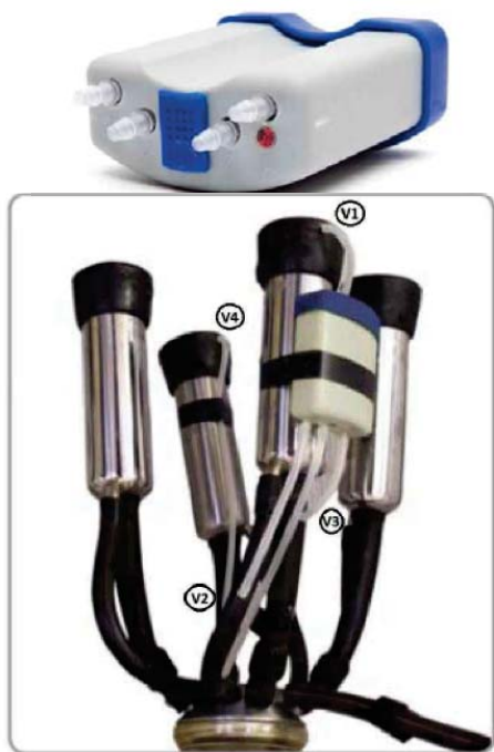
Figur 1. Vakuumblogger diagnose av melking. Eksempel på plassering av loggerenhet og tilkoplingspunkter.
