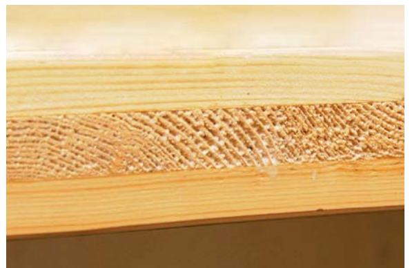
Tverrsnitt av yttervegg-element i massivtre.
