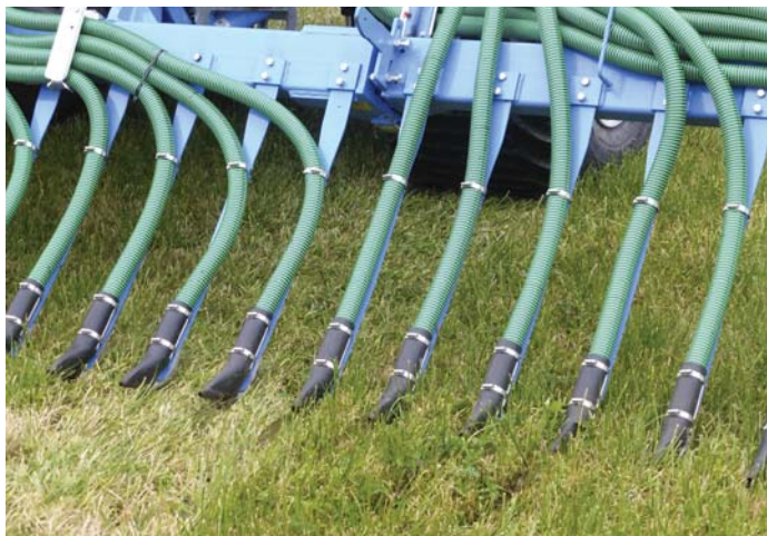
Nedfeller (Bomac) på tankvogn eller slangespreder
