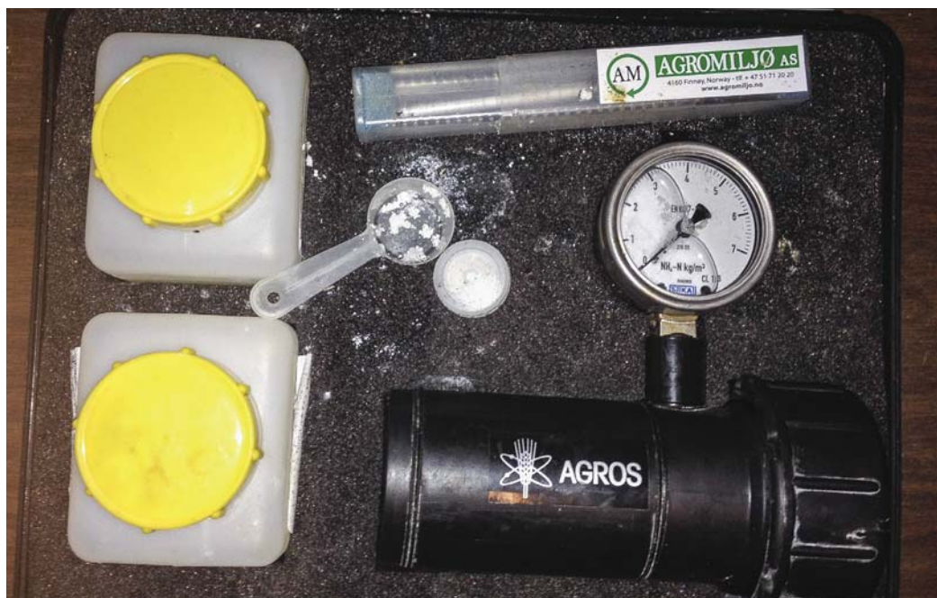
Norsk Landbruksrådgiving bruker Agrosmåler for hurtiganalyse av husdyrgjødsel. Resultatet avleses innen ti minutter som Kilo nitrogen/kubikkmeter.
