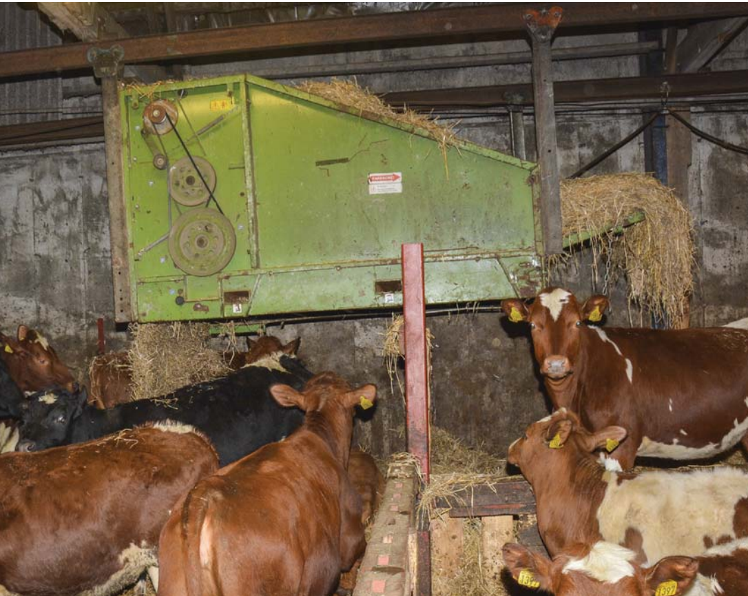
Brukt förriver ombygd til kabeldrevet halmutlegger. Billig og arbeidsbesparende!
