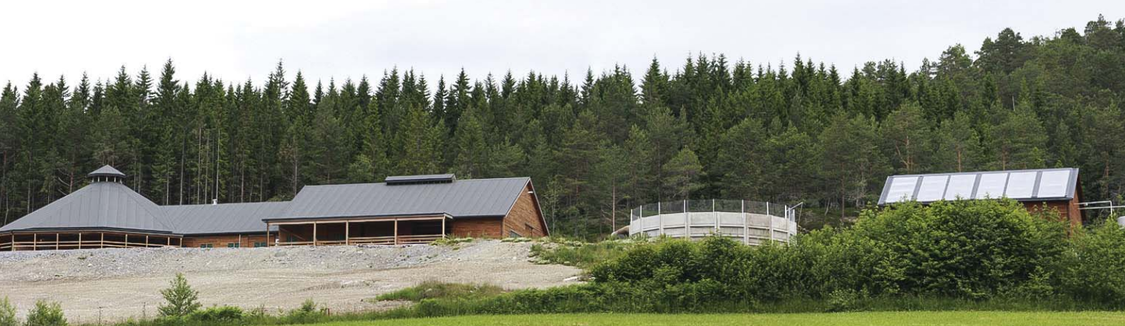
Rundfjøs med løsdrift for 25 melkekyr på Tingvoll gard, Nordmøre, bygd av Norsk senter for økologisk landbruk i 2010. Til høyre biogassanlegg med to råtnetanker (liggende), og kjøletårn (stående) for å avbryte biogassprosessen for lagring. Foto: Anita Land for begge bildene
