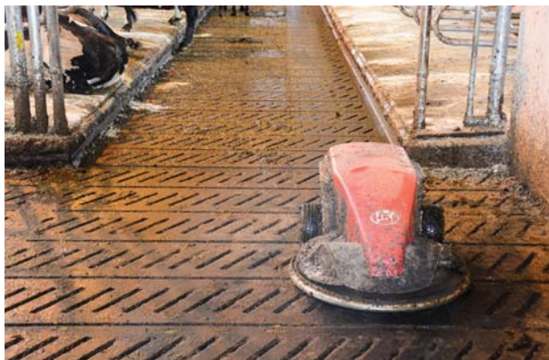
Robotskraper er ifølge Gunhild og Eivind et «must» for bra renhold.
