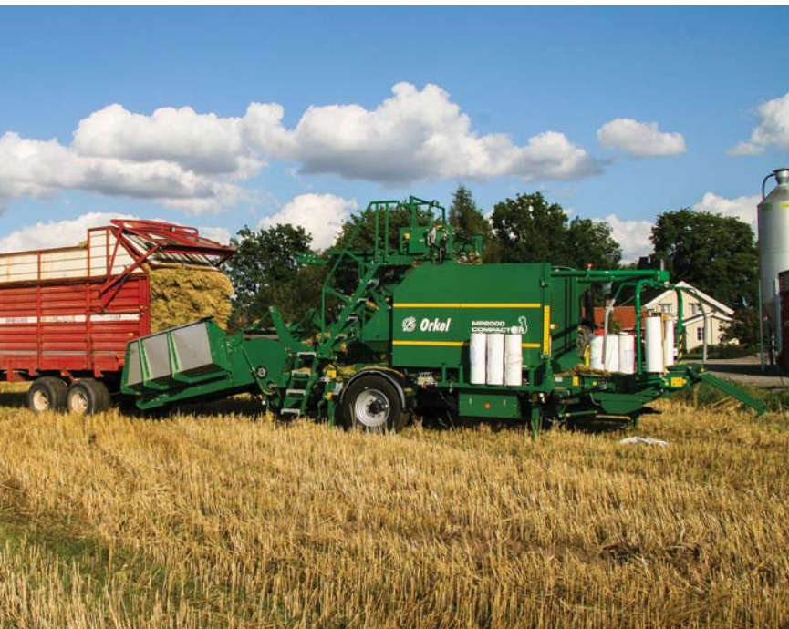
Kompaktoren (Orkel MP2000) er ei stasjonær kombipresse påmontert matebord og elevator for toppmating.
