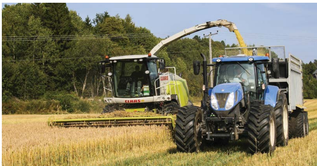
Helgrøde høstes ved deigmodning og gir en helt annen kvalitet enn vanlig grovfôr, og fôrverdien ligger først og fremst i innholdet av stivelse. Bildet viser høsting av hvetehelgrøde med selvgående finsnitter påmontert skjærebord for korn. Foto: Erik Brodshaug
