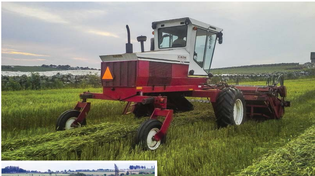
Hausting av kveite-åker uten raigras (sådde i beitemix for å bli beite neste år). Maskinen er ein Owatonna 290 med 4,5 meter skjærebord. Lettere modifisert til 1,4 meter rankebredde (var 2 meter då eg kjøpte han). 1992-modell kjøpt brukt i Danmark. Det er ein sak til ca. 100.000 kroner, men eldre utgaver omsettes frå ca 30.000. Foto: Privat
