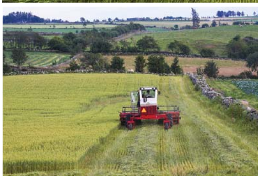
Hausting av kveite-åker uten raigras (sådde i beitemix for å bli beite neste år). Maskinen er ein Owatonna 290 med 4,5 meter skjærebord. Lettere modifisert til 1,4 meter rankebredde (var 2 meter då eg kjøpte han). 1992-modell kjøpt brukt i Danmark. Det er ein sak til ca. 100.000 kroner, men eldre utgaver omsettes frå ca 30.000. Foto: Privat
