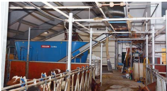
Med Pellon mikser og båndfôrfordeler, mener Stordal samdrift at de har fått et solid og driftssikkert fôringssystem.
