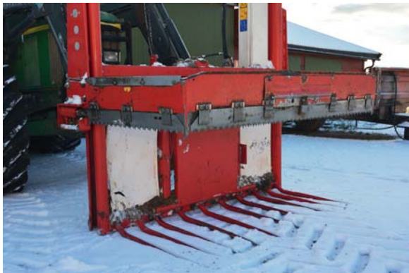
Uttak med Triolet blokkskjærer gir rette fine flater i silokummen.
