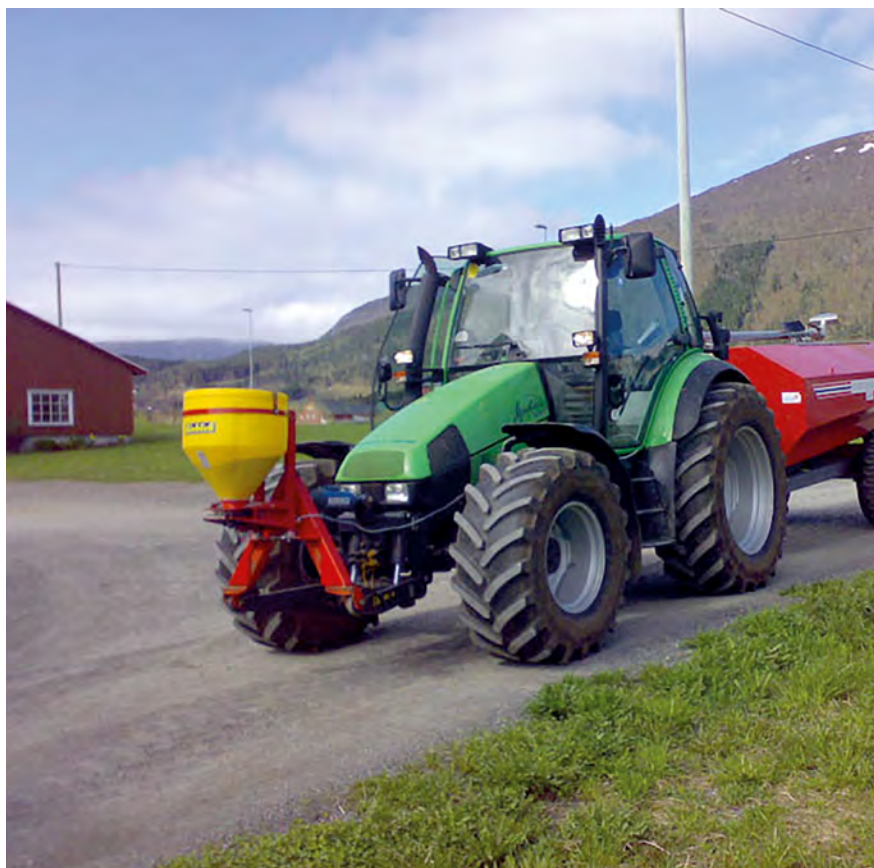
Direktesåmaskin med horisontalroterende fres påbygd såmaskin. Alt i en jobb.
