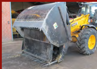
Silokutter, bredde fra 94 cm opp til 262 cm. Kan leveres med hydraulisk avskubber.
