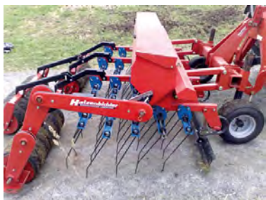
Såmaskin som legger frøet oppå bakken kombinert med ugrasharv for lett nedmolding.
