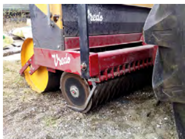
Spesialmaskin for grasfrø, med 8 cm såavstand i rader og rulleskjær som legger frøet ned i overflaten.
