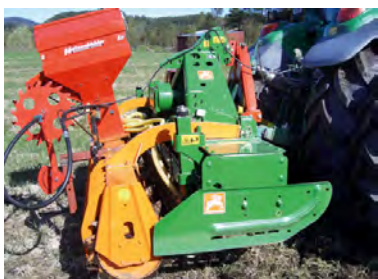
Enkelt utstyr og rask jobb for påfyll av frø der det er tynn eng. Spre frø med elektrisk drevet frønsåmaskin og legge møkk oppå.
