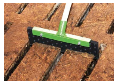
Spesialskrape til spaltegulv.
