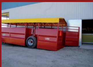
AgroX storfevogn hydraulisk heve/senke fra 4 m opp til 12 m.
