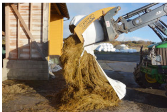
Med Tanco siloklipper går fyllingen av fullfôrvogna raskt og uten å måtte gå av traktoren for å fjerne plast.
