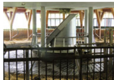
Rundfjøset sett innenfra. Høy og grovfor kommer automatisk ned på førbrettet i midten.
