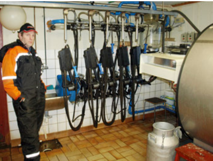
Mjølking av 32 kyr går unna på ein time og eitt kvarter med fem mjølkeorgan med automatiske avtakarar.
