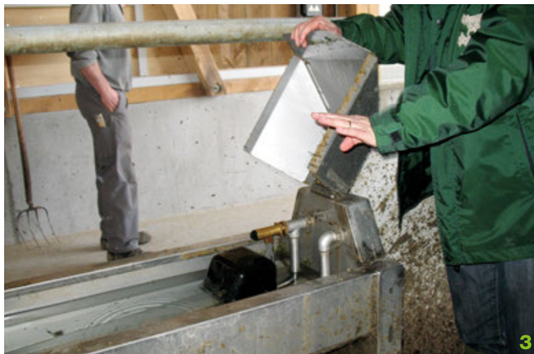
Noen typer drikkekar har også lett tilgang for rengjøring av flottør.
