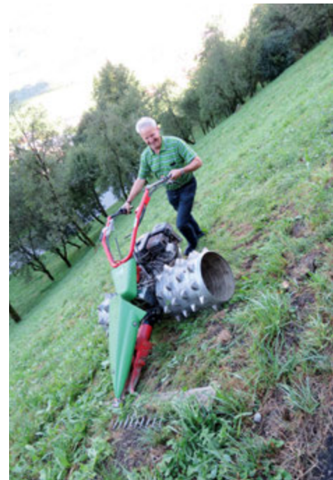
Den bratteste jorda på Rieshof slås med denne spesielle tohjulingen. Den har en valse med pigger og biter seg fast. Men det aller bratteste slås med hjå. Det gis ekstra tilskudd til alt bratt areal som slås.
