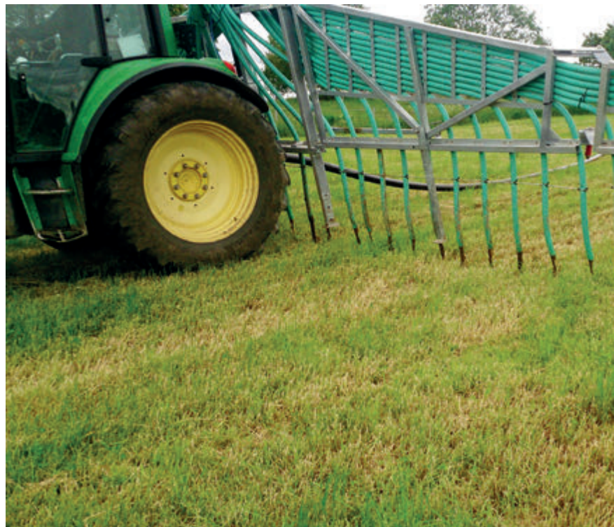
Med slepeslange i stedet for tankvogn får du sprederen tett på traktor og kan holde god avstand til bakken. Hold så nær jorda som mulig uten at du får oppbøying av slangene.
