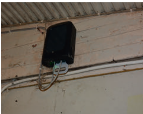
Antenne har ikke problemer med å fange opp signalene på transponderne på kvigene 30 meter unna.
