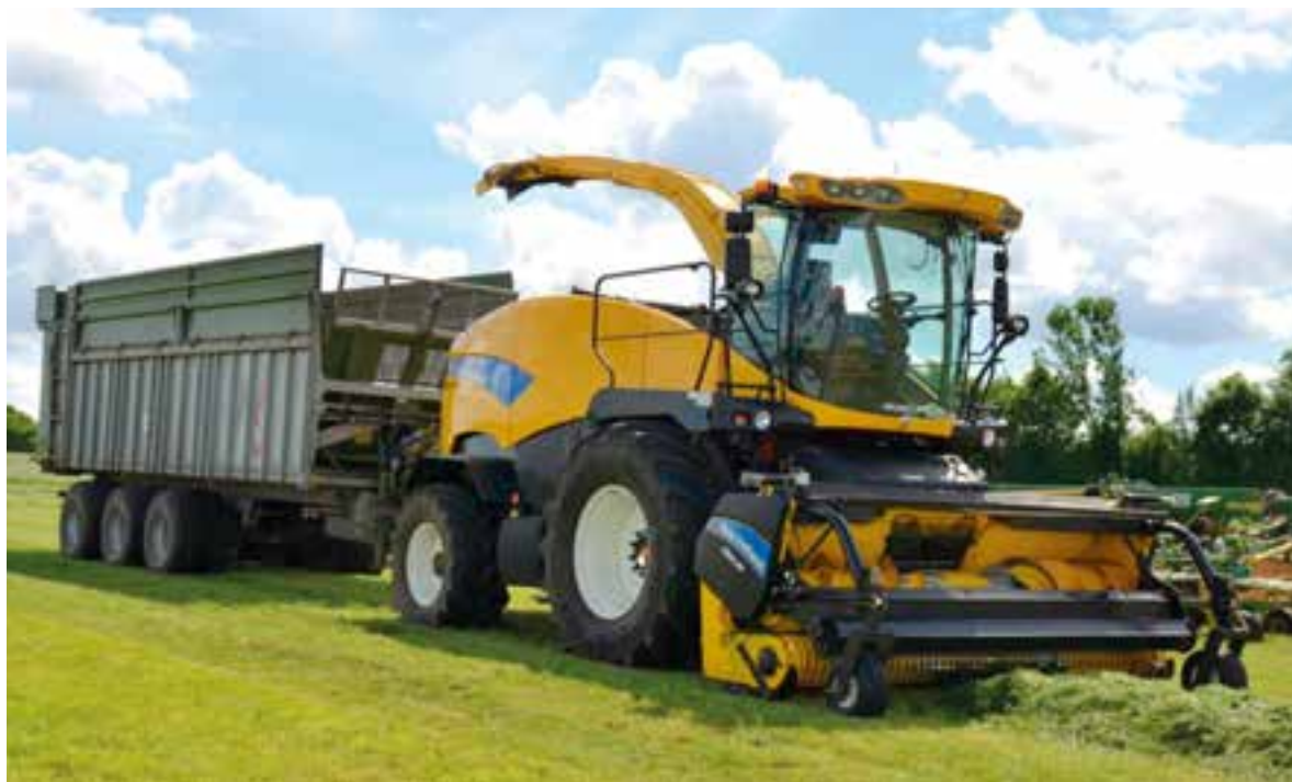
Finsnitter og faste kjørespor. Finsnitter med hurtigkopling til bakmontert vogn til inntransport slik at gjødselvogn, skårlegger, rive og finsnitter kan kjøre i samme spor, så tilfeldig kjøring på graset unngås. Foto: Peter Hvid Laursen
