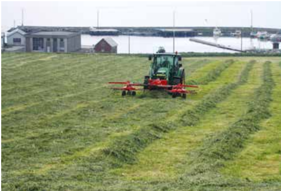
Ved breispreiing må ein nytte samlerive ein gong. Ved frontmontering av riva unngår ein å køyre i grasstrengen. Foto: Olav Martin Synnes
