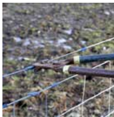
Gjerdene kan etterstrammes med ei grippeltang.
