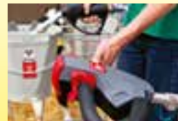
Håndtak med nødstop. Trykkbryter for utdosering. Fingertupp kontroll på drift.
