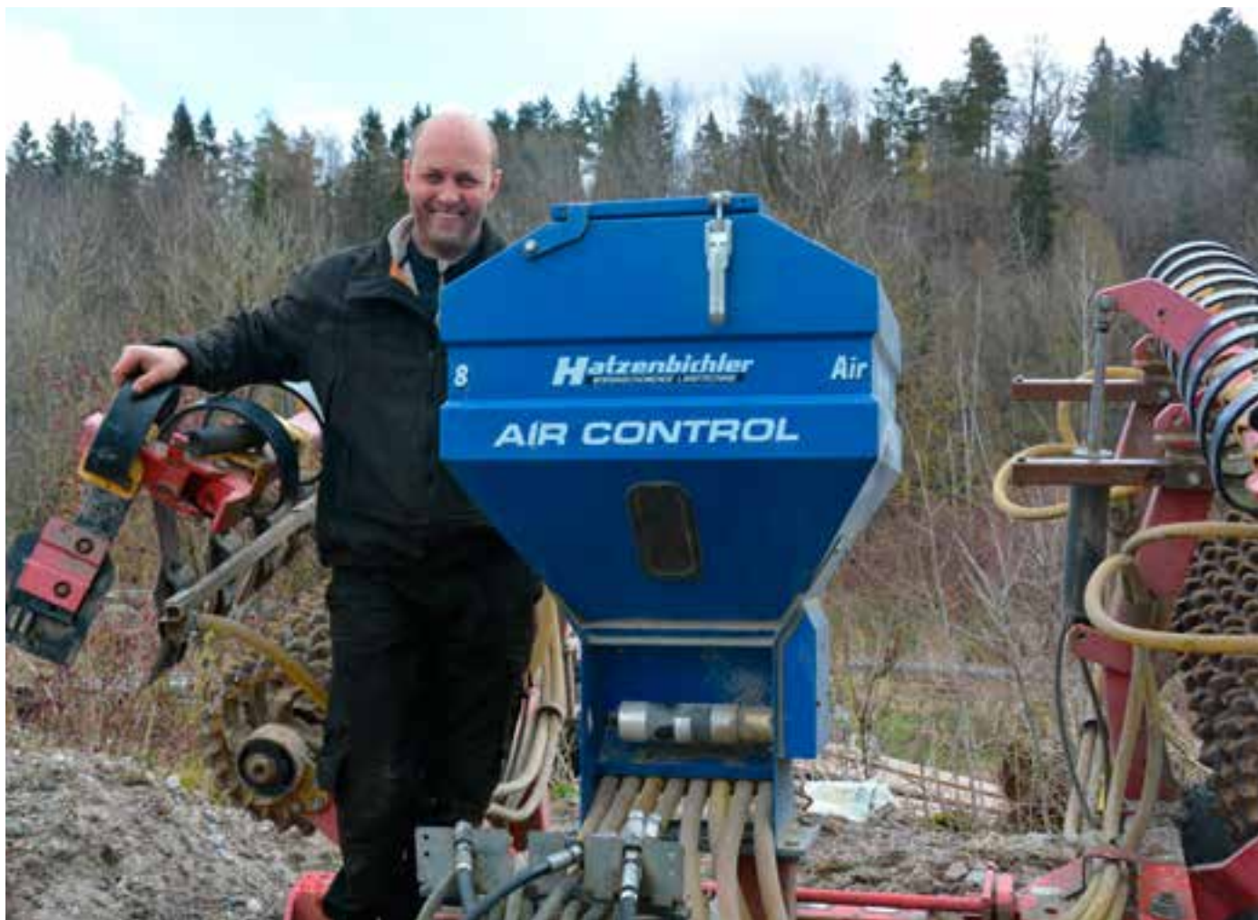
Lars Vassend sparte en arbeidsoperasjon og fikk utvidet arbeidsbredde da han monterte grasfrømaskin på trommelen.
