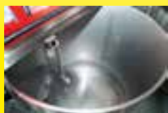
Tank med mengdegradering. Holder til pistol ved vask. Omrører langsam/hurtig.
