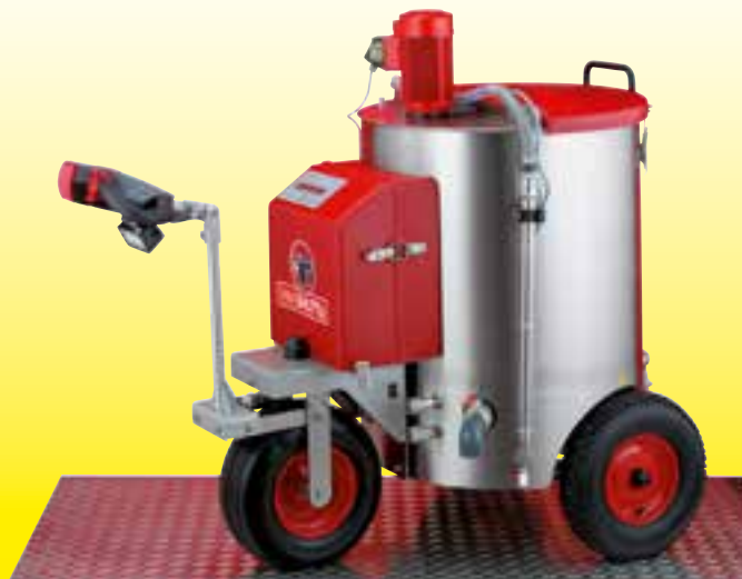
Motor for omrører på toppen. Ingen gjennomføring i tankbunnen. 2 hastigheter på omrører. Komputerkontrollert varme. 3 taster for forhåndsinnstilling av melkemengde. Også tildeling kontrollert av telleverk.
