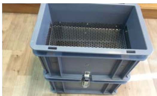
Bilde 1. En fibertest utføres ved å vaske gjødsl gjennom siler med ulik porestørrelse.
