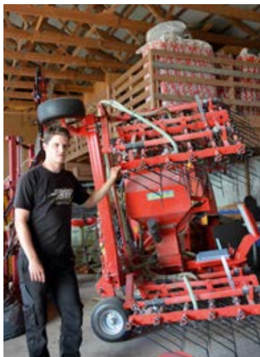
Denne såmaskina gir fin breispredning av grasfrø, og det kan være mulig å redusere mengden ned mot 2 kg/dekar ved optimale forhold. 100 000 kroner er prisen og samarbeid med nabo halverer prisen.
