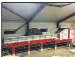
Serigstad Exactfeed – rundballekutter med integrert magasin som automatiserer grovfôrhandteringa.
