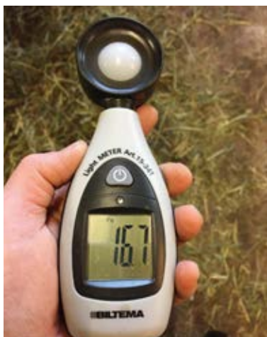
Lysmålarer viser nok lys rett under lysrøret, men på «skuggesida» av H-bjelken så fell styrken heilt ned til 38 lux. Det er altfor lite lys.
