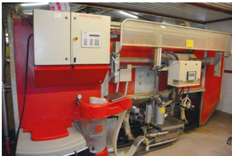
Denne tilårskomne roboten kan fortsatt melke forutsatt at det er deler å få tak i og at ramma som kun er galvanisert holder.
