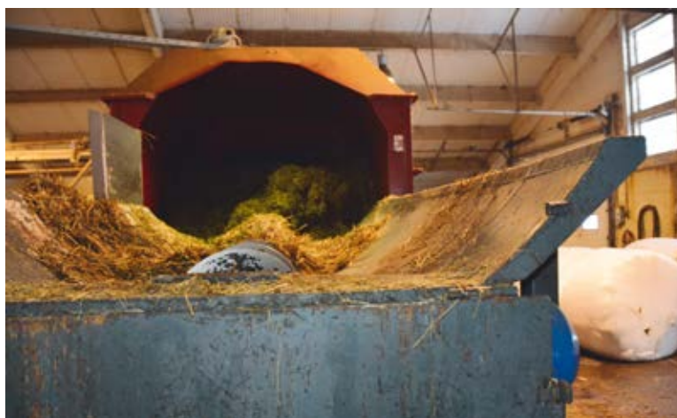
Fullfôrmikser utviklet i fjøset, med lavt energibehov
