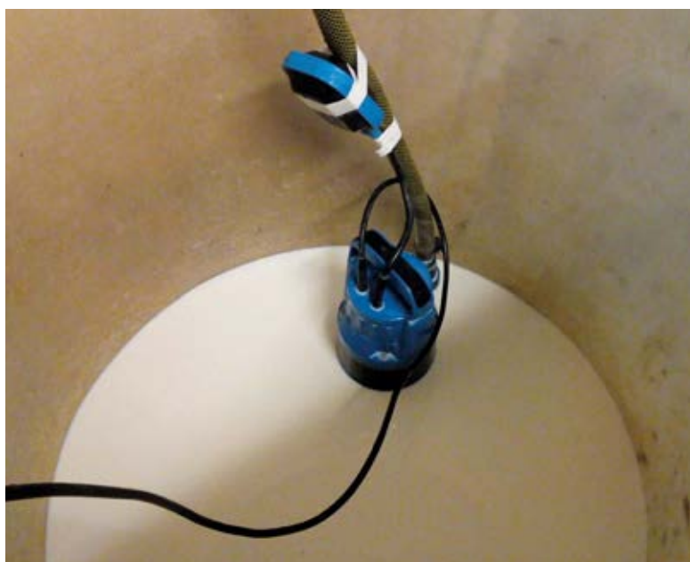
På vannpumpe fra Biltema lurar han flåtoeren med å teipe den opp, så han får opp all melka fra syrningstanken.
