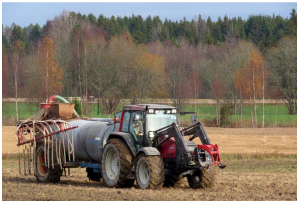
Gjødselspredning med gjødselnedlegger gir mindre N-tap. Det utløser også ekstra tilskudd i enkelte områder. Men nyere undersøkelser viser at lystgassutslipp sannsynligvis øker. Og lystgassutslipp er svært uheldig for miljø. I sum kan derfor slik spredning kanskje ha negativ miljøeffekt?
