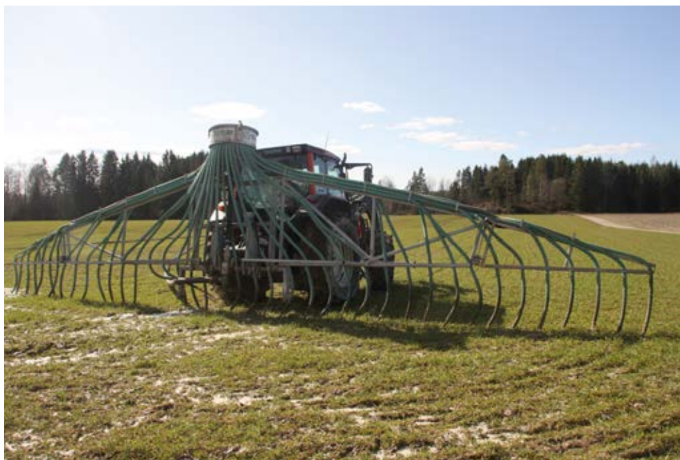
Gjødselspredning med slepeslanger og stripespreder blir fort mer lønnsomt enn tankvogn der forholdene ligger til rette for det.
