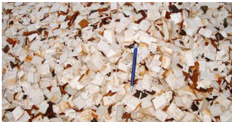
Treflis som matte i overgang mellom driftsveg og beiteareal må vere så grov at vatn drenerer ned gjennom laget.
