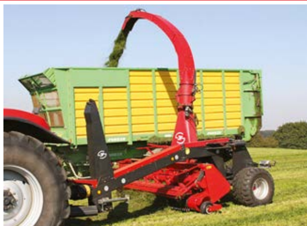
FCT 1060, 1260 Nyhet!, 1360 og 1460 MD slepemonterte eksaktsnittere fra 1,8 til 3,1 m pickup. 1060, 1260 og 1360 kan leveres med med metalldetektor også.
