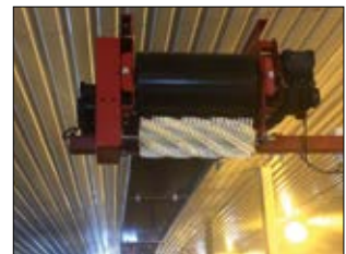
Takutfôring fra FjøsSystemer – fleksibelt system for automatisk utfôring på én eller to sider på fôrbrettet. Kan leveres med applikasjon til mobiltelefon.
