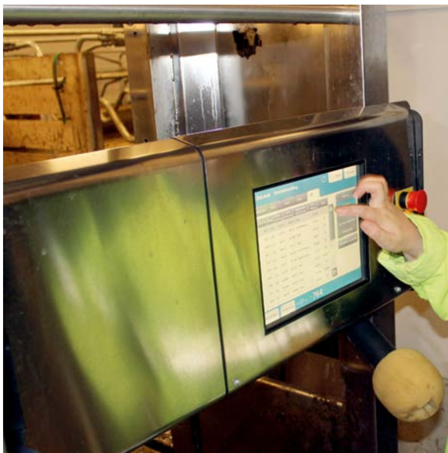
I mjølkerobotens display kan Jørgen Langbekkhei fra Os, bonde in spe, se både individnummer og mjølkemengde mens mjølkinga pågår. Foto: OS ID
