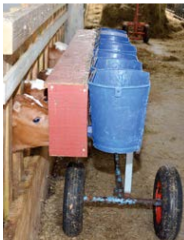
Sønnen Vegards kalveføringstralle er bygd av gamle deler og gir rasjonell kalveføring.
