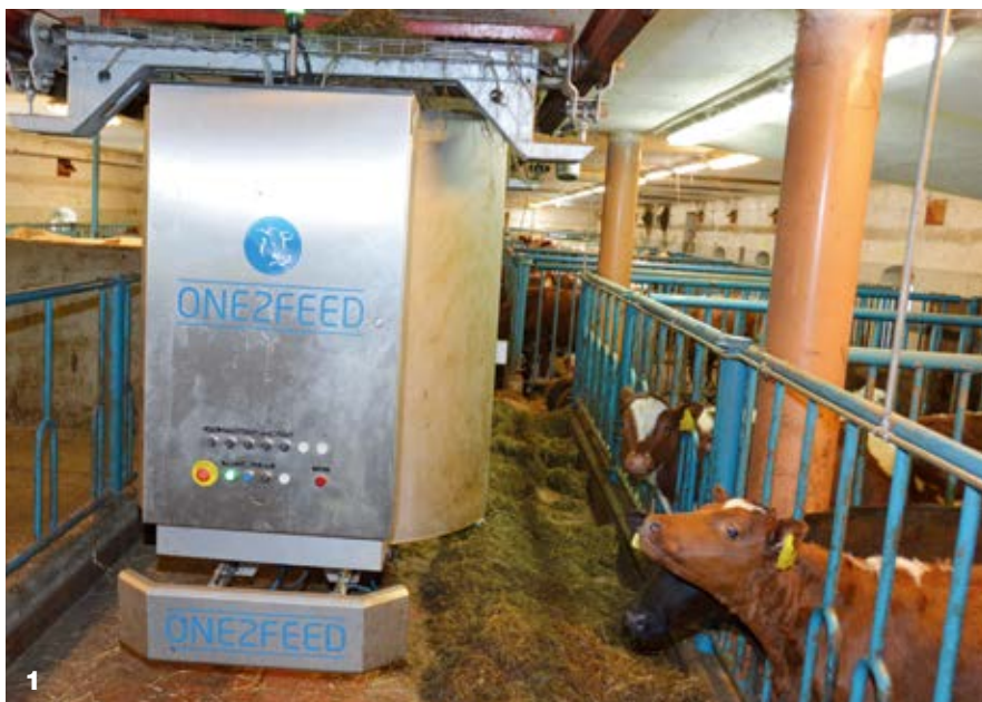
One2Feed er bygd i rustfritt stål (bilde 1), har to vertikale blandere (bilde 2) med kniver og vogna henger i vektenheten (bilde 3).
