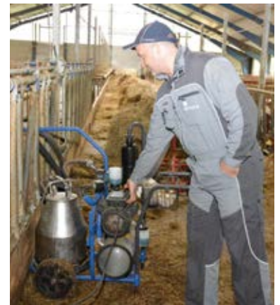
Med mobil melkeenhet («melkemoped») er det enkelt å melke kyrne i kalvingsavdelingen.
