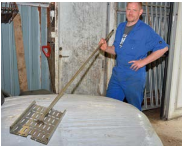
Vidar Mokleiv med sin spesialkonstruerte spade – lagd av kabelgater – for å gjøre rent under treplattingen i kalvebingene.
