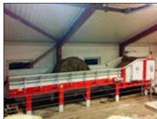
Serigstad Exactfeed – rundballekutter med integrert magasin som automatiserer grovfôrhandteringa.
