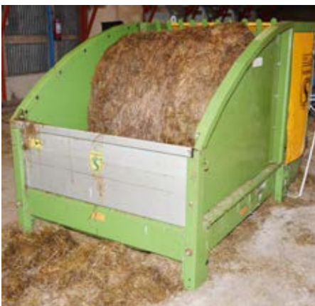
Den gamle Serigstad Flexifeed har blitt ombygd og fått et nytt liv som mater for mikser- og distribusjonsvogna.
