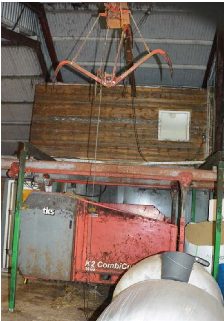
Rundballerivere var i undersøkelsen den vanligste tekniske løsningen for riving og oppdeling av grovfôr. Foto: Rasmus Lang-Ree
