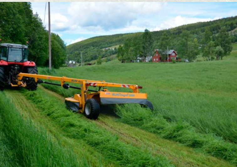
Stubben etter den nye slåmaskina blir ikke like jevn som forventet, Jan Erik tar seg tid til justering.
