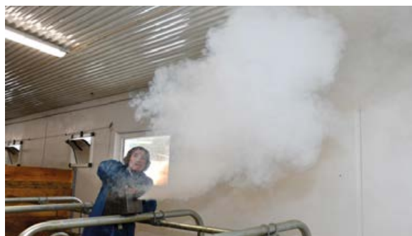
Siden det er for langt fra gavlvegg til første ventil blir det litt stillestående luft i dette hjørnet.
