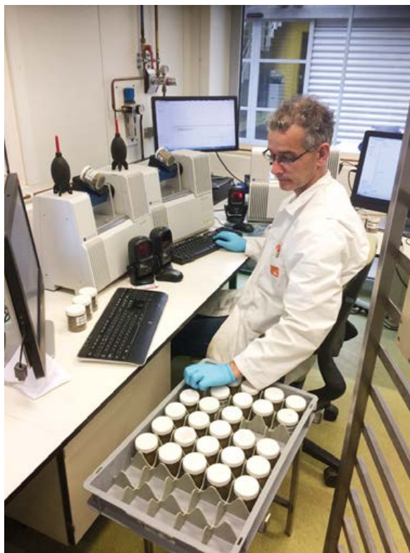
Tre NIR instrumenter utgjør selve kjernen i Eurofins Agros grovfôrlaboratorium i Wageningen (tidligere kjent som BLGG).
