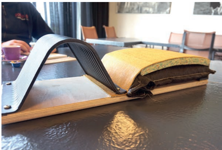
Snitt av en madrass som består av flere lag, det underste av knuste bildekk som gir god demping.
