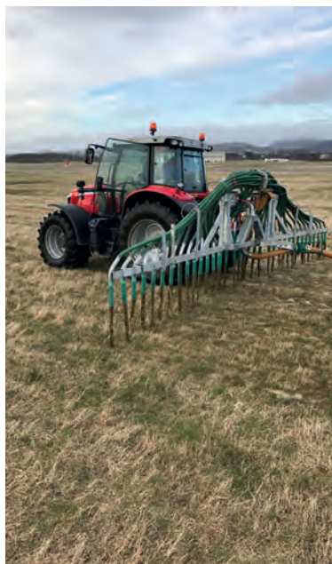
Traktoren har spredebom på 9 m. Foto: Audun Stålesen
