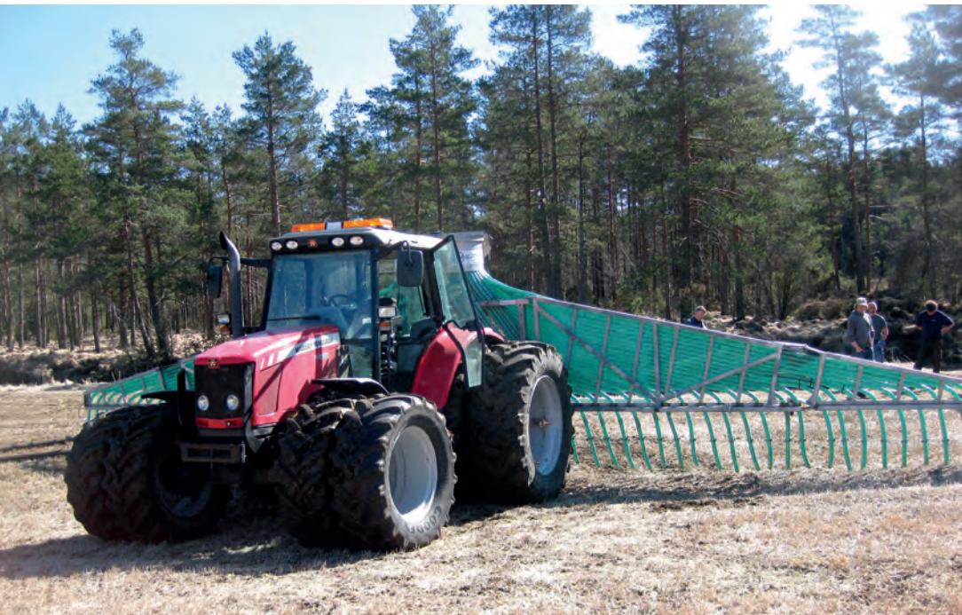
Husdyrgjødselspredning med slangetilførsel og stripespreder på traktor med tvillinghjul gir veldig lav jordbelastning. Foto: Jan Karstein Henriksen
