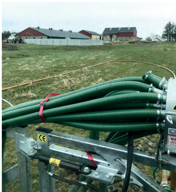
Fordelersystemet gir en jevn spredning på jordet. Foto: Audun Stålesen
