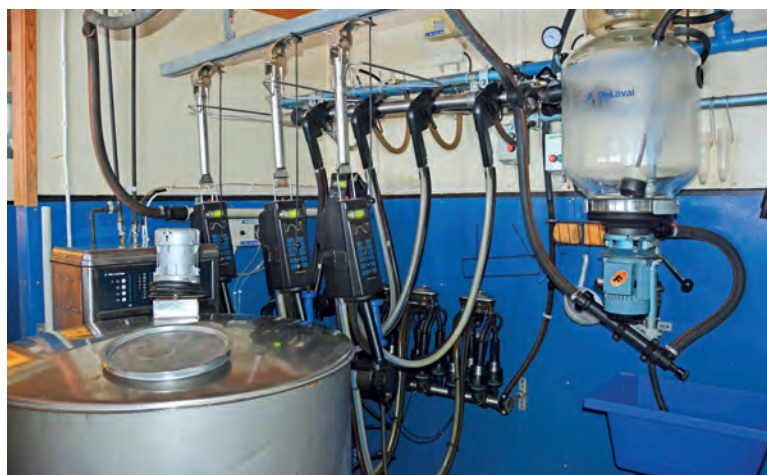
Produksjonen har vokst ut av mjølkerommet, og fjøstegningene innebærer et nytt tankrom. Nå er det satt inn en ekstra tank for å ta hånd om toppen av produksjonen.
