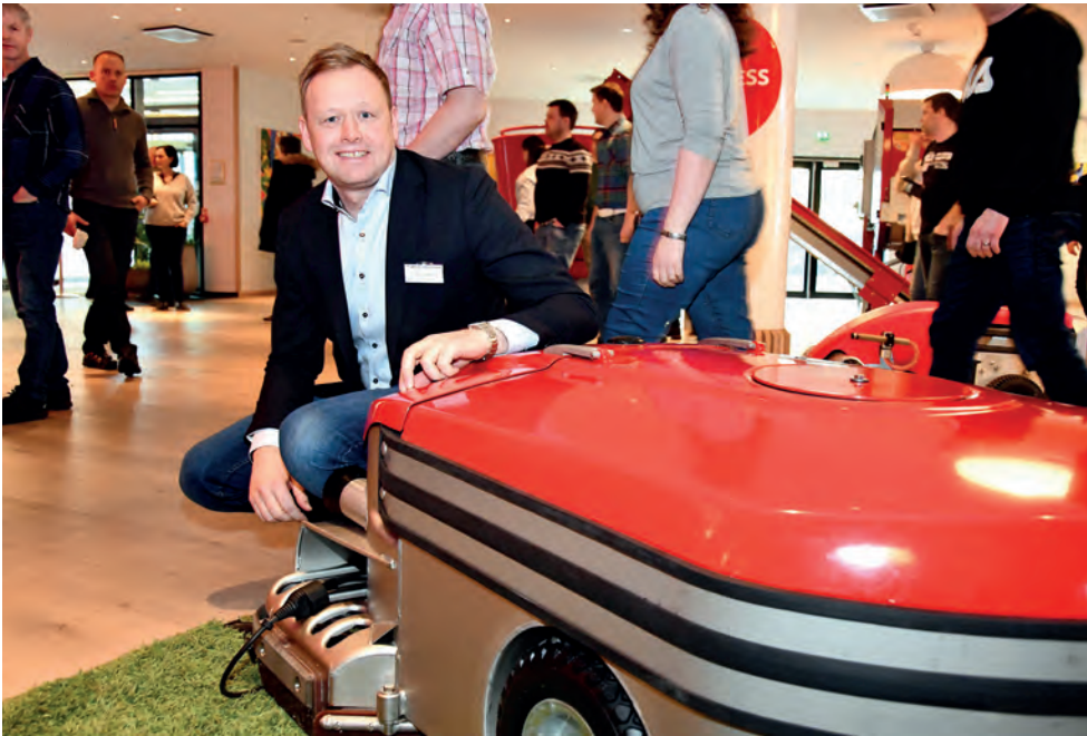
Daglig leder i Fjøsssystemer AS, André Stenumgård, med nyheten Lely Dicover Collector, skrapperobot for faste gulv. Den både skaper og samler opp gjødsel. Den er allerede i drift i det første fjøset på Jæren.
