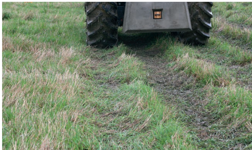
Gode dekk er viktig. Bildet viser hjulspor etter samme traktor. I sporet under traktoren var lufttrykket på 1,6 bar. I sporet til venstre var lufttrykket 0,65 bar. Overflata spares, men marktrykket går fortsatt langt ned i bakken.
