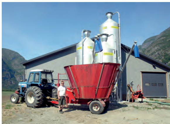
I denne miksaren som han koplei til traktoren, lagar Jens Reidar grunnmiks til kyrne og fullfôrmiks til sinkyrne. Dette fôringssystemet er enkelt og driftssikkert.
