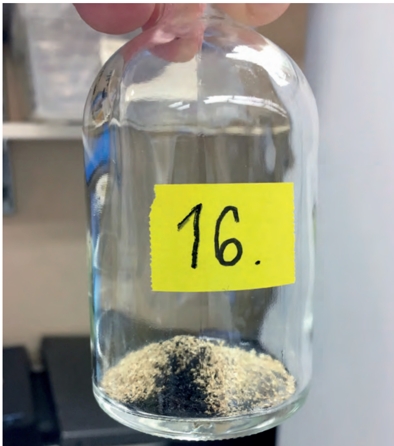
En in vitro flaske med norsk biokull og substrat (fôr). Dette er rett før tilsetning av vomvæske og bufferstoffer. Flasken blir så forseglet og plassert i varmeskap under omrøring. Så tas det ut gassprøver hver 3 time over et helt døgn for å undersøke hvor mye metangass som produseres.
