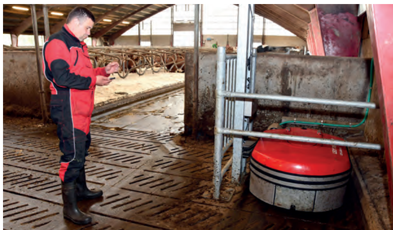
Asgeir Pollestad styrer roboten via en app på telefonen. Foreløpig bare for android-telefoner, men det vil komme også for iPhone. I ladestasjonen får roboten også fylt opp de to posene med vann.
