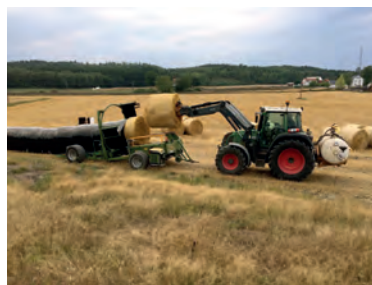
Pøsepakkeren er et nyttig redskap ved ammoniakkbehandling av halm.
