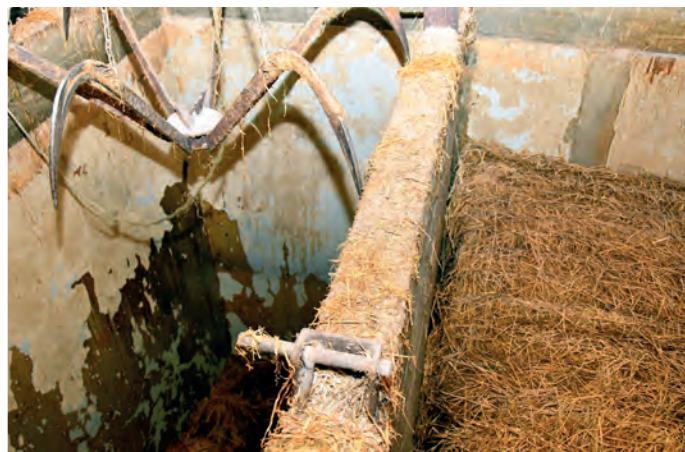
Dypplutingsanlegget består av tre kummer med plass til fire rundballer (1,50 meter) i hver kum.
