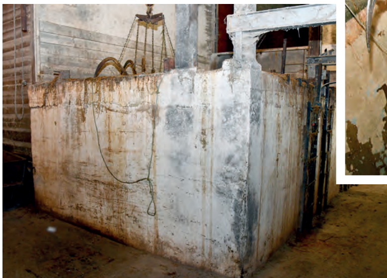
Dypplutingsanlegget består av tre kummer med plass til fire rundballer (1,50 meter) i hver kum.
