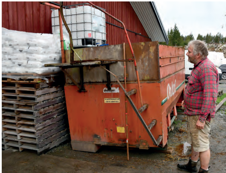
Gammelt Orkelutstyr «sveiset om» til lutingsanlegg med kapasitet til to halmballer. Ballene ligger i ett døgn etter luting før de brukes og ballene veier da 750–800 kg
