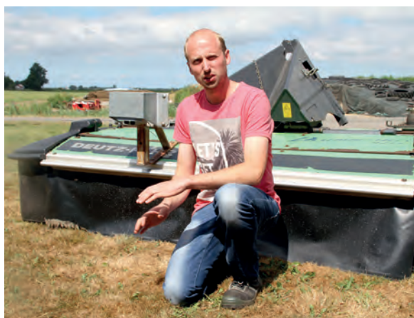
Piet Jan Thibaudier har montert på et kamera som måler grasets vekst (pasture reader) på slåmaskin. Både tetthet og høyde på graset måles og dermed avling.
