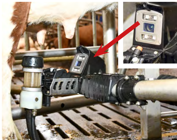
3D kamera og ny programvare gir raskere og mer presis påsetting og redusert bokstid. V300-roboten kan også spraye spenene både før og etter melking, men i Røyneberg samdrift brukes bare spraying med den jobbaserte Tri-Fender etter melking.
