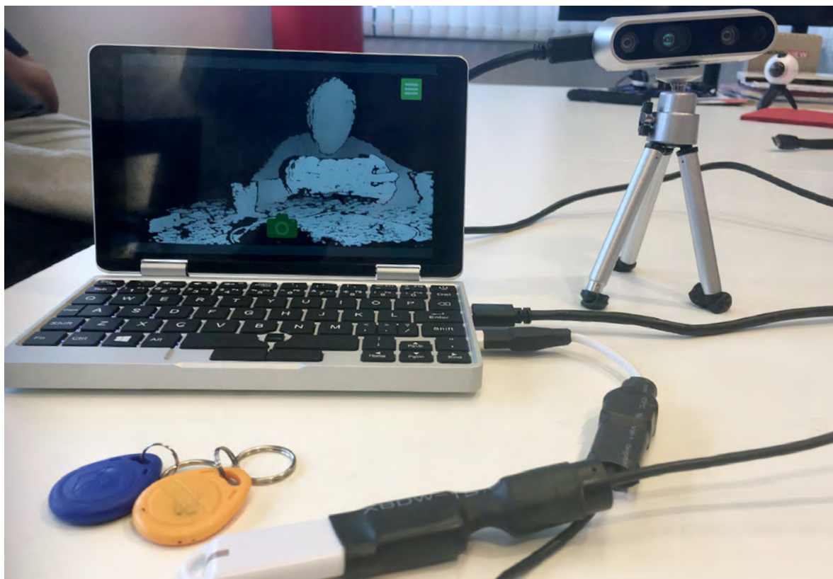
Figur 1. Mini-datamaskinen med tilkoblet RFID-leser og 3D-kamera, før innkapsling og oppmontering. På dataskjermen vises et 3D-bilde av artikkelforfatteren i det dette bildet ble tatt, der objekter som er nær kameraet er hvite, mens objekter lengre fra kamera er mørke.
