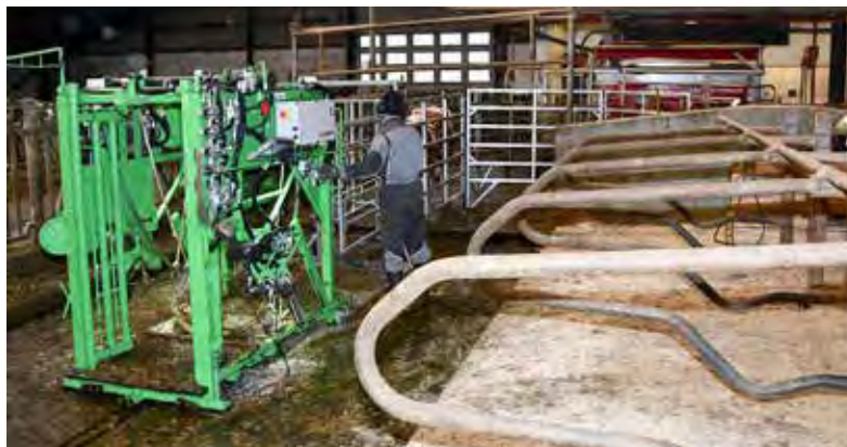
Bildet viser oppsettet med lettmetallgrinder for oppsamlingsplass foran melkerobot og drivgang inn i klauvboks.
