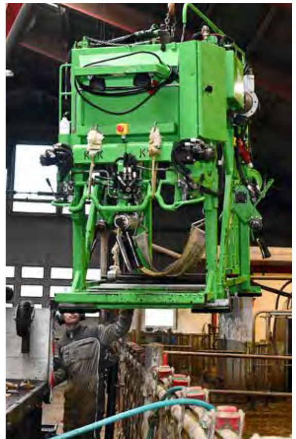
Klauvboksen heies med egen kran.
